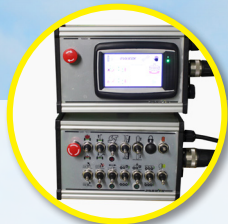
Commande électro- hydraulique avec terminal Touch Control ou Isobus
